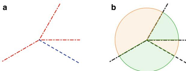
**Abb. 1.13** (a) Illustration zu Theorem 1.6.1. (b) Illustration zu Theorem 1.6.2. Talfalten sind gestrichelt, Bergfalten strichpunktiert dargestellt.
