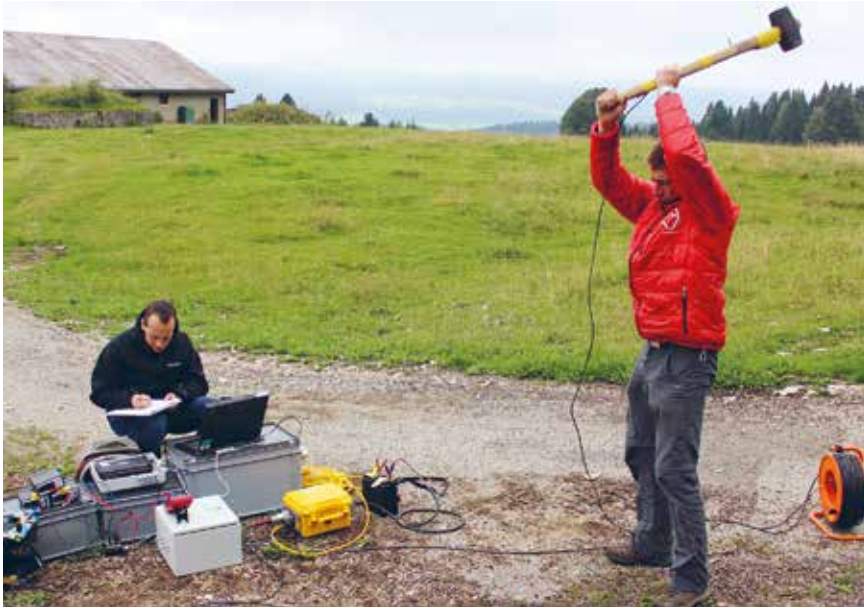
Abbildung 1: Ein Team der Forschungsgruppe ACADEMIA der KS Wattwil erzeugt und untersucht kleine Erdbeben. Saubere Geophysik oder schmutzige Fracking-Technik? – Sicher eine erfolgreiche Form von MINT-Förderung!
