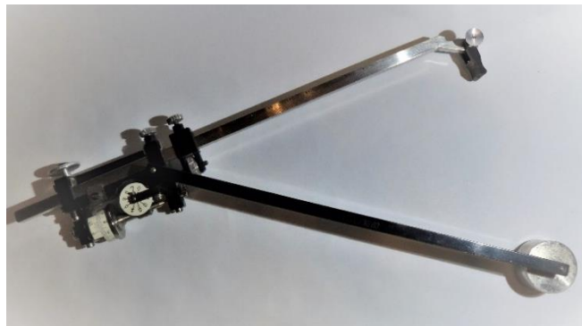
Abbildung 3: schematisiertes Polarplanimeter Abbildung 4: industriell hergestelltes Polarplanimeter (Aus technischen Gründen befindet sich das Messrad neben dem Tracerarm. Wichtig ist, dass die Radachse parallel zum Tracerarm ist.)
