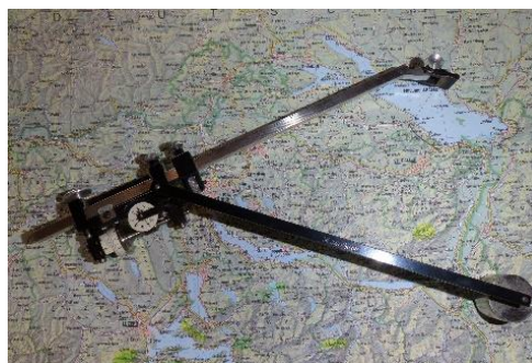
Abbildung 6: industriell hergestelltes Polarplanimeter, für eine Umfahrung im Uhrzeigersinn um den Bodensee angeordnet
